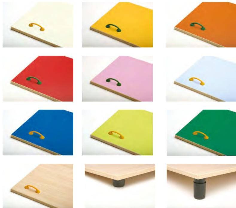
Fabricados con tablero laminado en haya de 19 mm de espesor y trasera de 10 mm. Cantos de PVC de 2 mm de espesor acabados por ambas caras. Pies niveladores de PVC de Ø40 mm, regulables en altura para evitar la humedad y desniveles que pueda tener el suelo. Tiradores fabricados en un polímero suave y flexible para evitar lesiones al golpearse. Cubetas combinables en color y tamaño, dos cubetas pequeñas pueden sustituirse por una grande.
